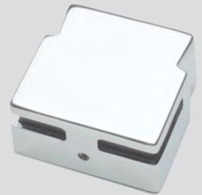
*Los cabezales de vapor ComfortFlo garantizan que cada el baño de vapor es seguro y placentero. El vapor se envía a la habitación a través de un aislante de plástico Ryton interno, evitando que la superficie metálica exterior alcance altas temperaturas. El cabezal de vapor ComfortFlo presenta un depósito de fragancia que permite al bañista disfrutar de los beneficios de la aromaterapia al agregar su fragancia favorita al depósito.*
