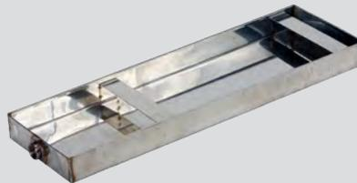
*Diseñado para usar con los generadores de vapor Amerec AX y AK. Cuando se instala correctamente y se conecta a una línea de drenaje adecuada, la bandeja de goteo ADP atrapa y drena cualquier fuga de agua en la instalación. Presenta una construcción de acero inoxidable con esquinas soldadas y un accesorio de acero inoxidable de 3/4 "*
